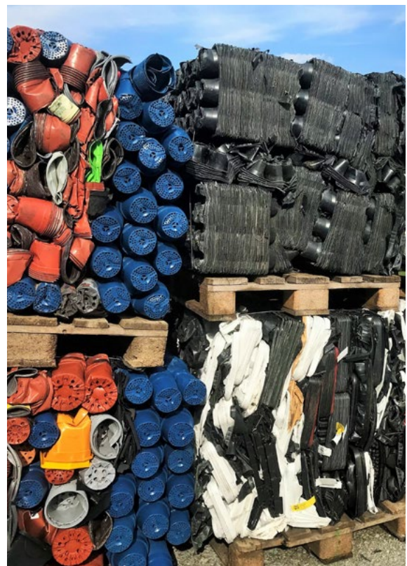
Töpfe, Trays und andere recycelbare Entsorgungsgüter werden für die Lagerung beim Topfpflanzenproduzenten und den Transport zum Kunststoffrecycling-Werk zu Ballen gepresst. Das benötigt dreimal weniger Platz und spart Transportkosten.
