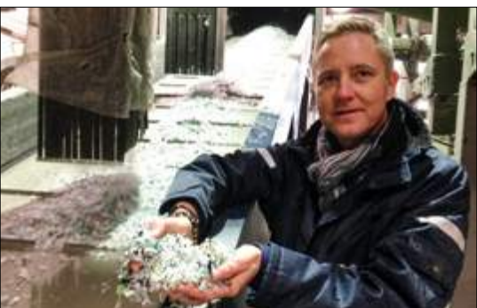
Markus Tonner: So sehen die gewaschenen und getrockneten LDPE-Schnitzel vor dem Extrudieren aus.
